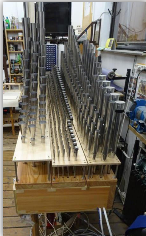
Obr. 31: Nová vzdušnice s píšťalami rejstříků Trompeta. 8' a Cornet 5 nás →
